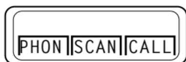
Pulse el botón situado debajo de SCAN para comprobar que el modo seleccionado mediante el selector de modo (3) y el interruptor de palanca de tres posiciones (6) se encuentra en la lista.
